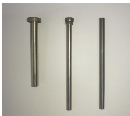
图8 研制的120#电镀CBN砂轮
